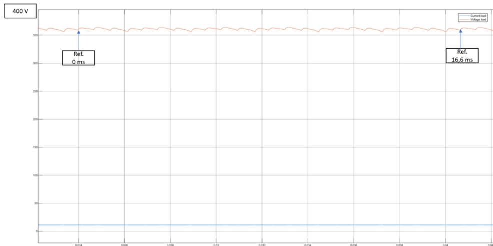
Figura 29. Salida de 24 pulso con nivel de tensión de 400 Vdc en el punto de alimentación TAP 2 - 208 Vac.
