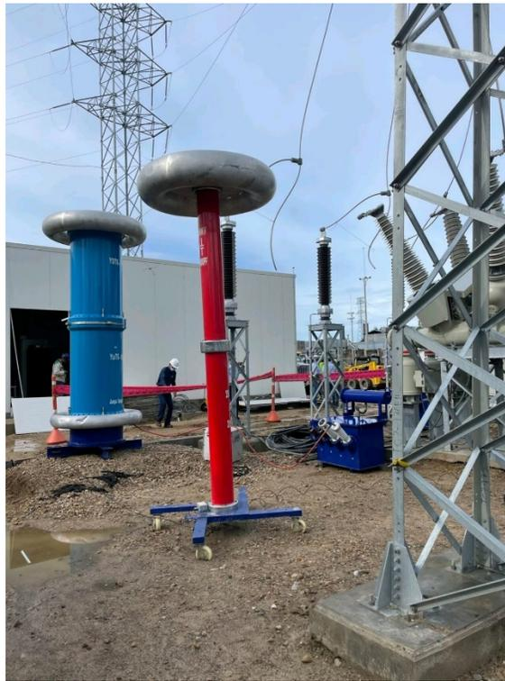
Figura 1-2. Disposición física de los equipos que componen un sistema resonante de alta tensión, sistema de frecuencia variable en una subestación. (Elaboración del autor, 2022)
