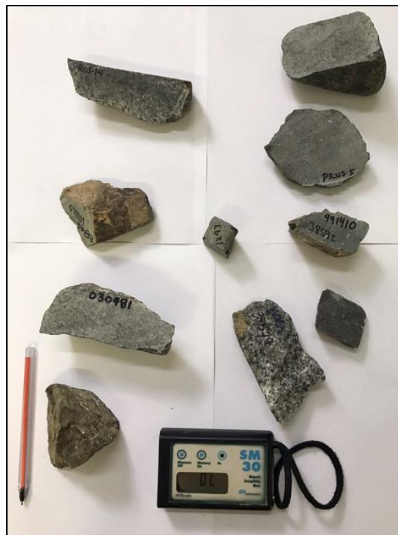
Figura 25. Toma de susceptibilidad magnética en muestras de rocas del área de Panamá.
