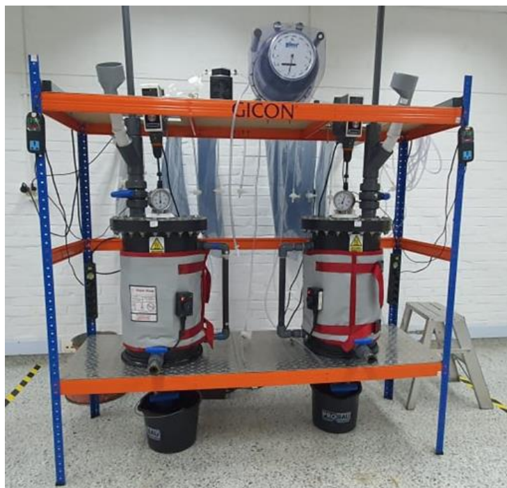
Figura 3-1: Reactores, a la izquierda R-Z (reactor con adición de zeolita) y a la derecha R (reactor sin adición de zeolita) en planta piloto de biogás del Centro Internacional de Agricultura Tropical- CIAT
