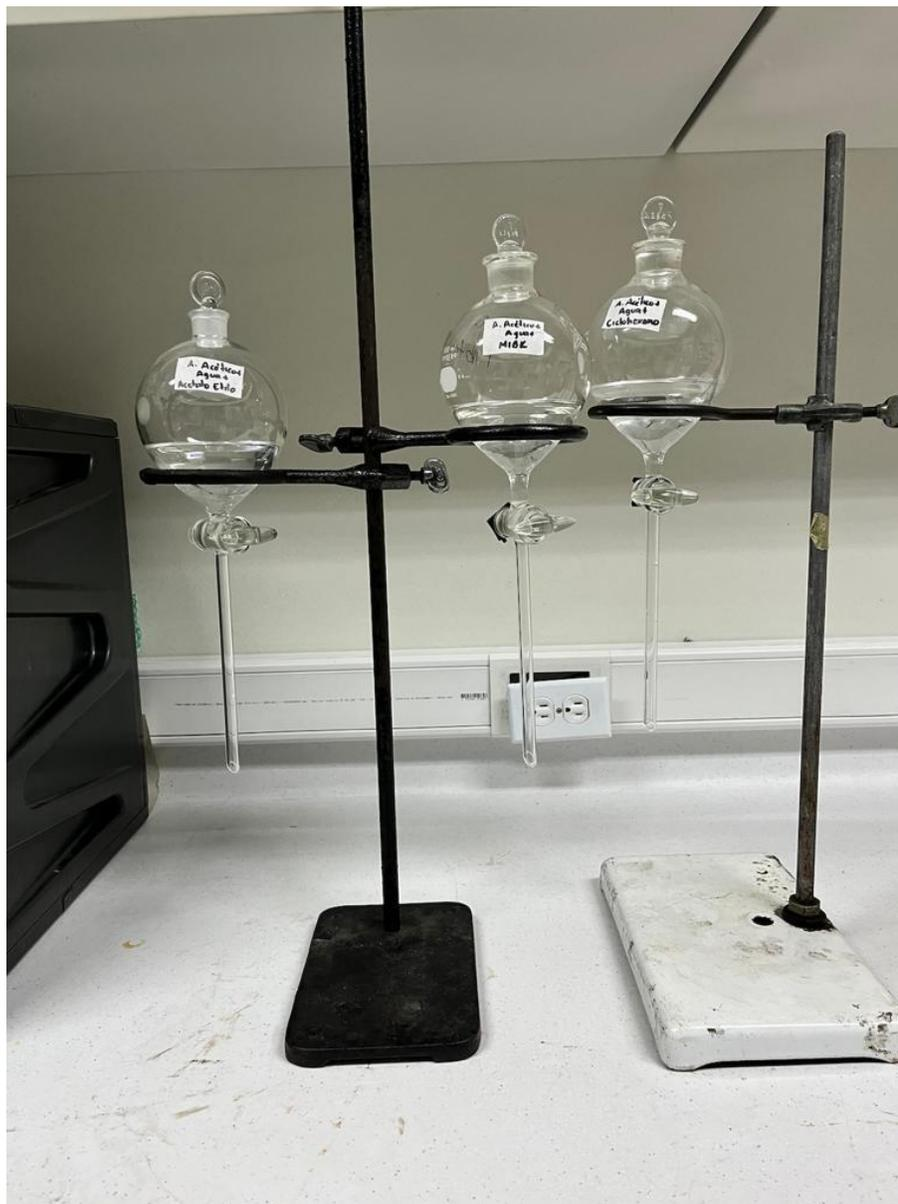
**Figura F-2:** Montaje realizado para las extracciones realizadas en el sistema AA/W. con distintos solventes. Izquierda: Acetato de etilo (AE), Centro: Metil Isobutil Cetona (MIBK), Derecha: Ciclohexano (CyC6).
