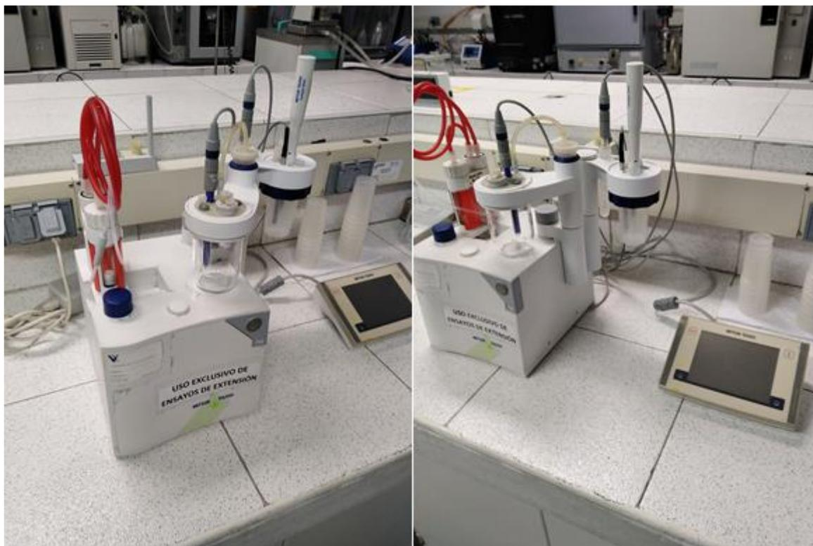
**Figura H-1:** Montaje experimental Karl Fischer para determinación de la concentración final de agua en la fase orgánica.
