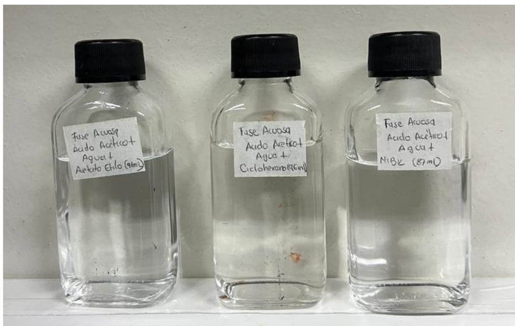
**Figura F-4:** Fase acuosa obtenida para el sistema AA/W. Izquierda: Acetato de Etilo (AE), Centro: Ciclohexano (CyC6), Derecha: Metil Isobutil Cetona (MIBK).
