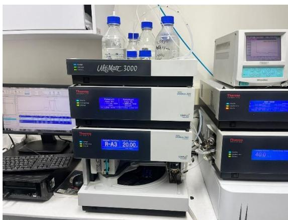
**Figura G-1:** Montaje experimental HPLC para la determinación de concentración final de ácido en fase acuosa.
