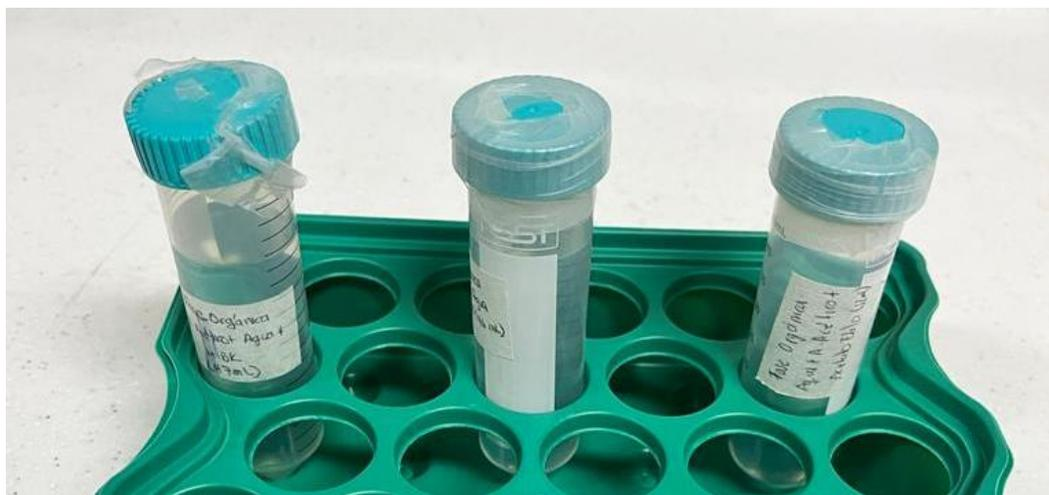
**Figura F-6:** Fase orgánica obtenida para el sistema LAW. Izquierda: Metil Isobutil Cetona (MIBK), Centro: Ciclohexano (CyC6), Derecha: Acetato de Etilo (AE).
