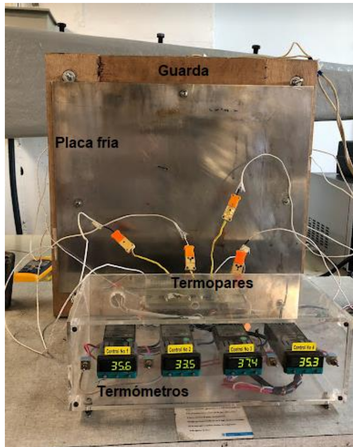
Figura 3-19 Montaje del sistema placa caliente en funcionamiento
