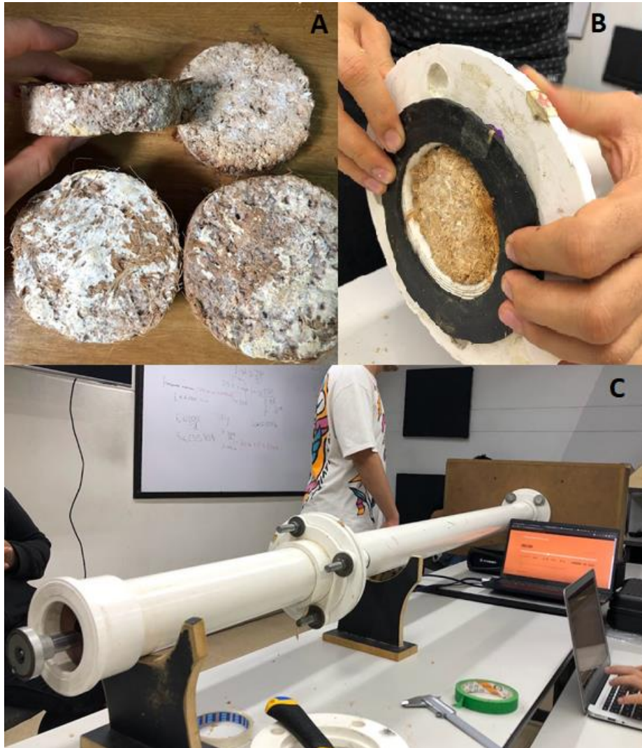
Figura 3-24 Ensayo acústico A. Muestras de biomaterial B. Muestra en extremo del tubo. C. Tubo de impedancia
