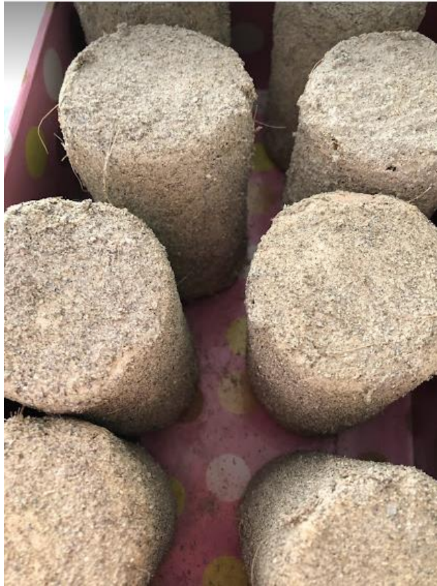
Figura 3-6 Recubrimiento - Mortero de cal sobre cilindros
