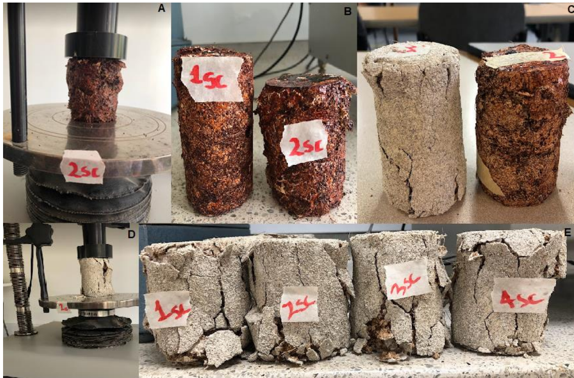
Figura 3-10 Deformación de muestras A: Montaje muestra sin chips – Quebracho. B: Deformación. C: Deformación según recubrimiento. D: Montaje muestra con chips – Cal. E: Deformación muestras sin chips – Cal.
