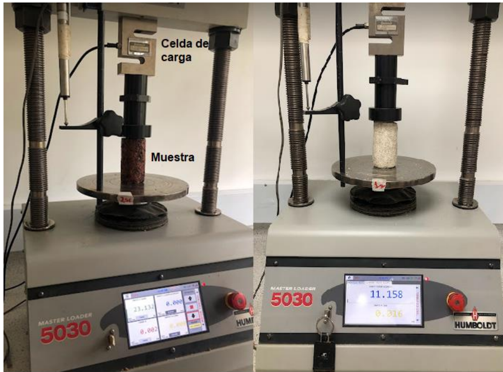
Figura 3-9 Montaje ensayo a compresión – Recubrimiento quebracho y recubrimiento mortero de cal
