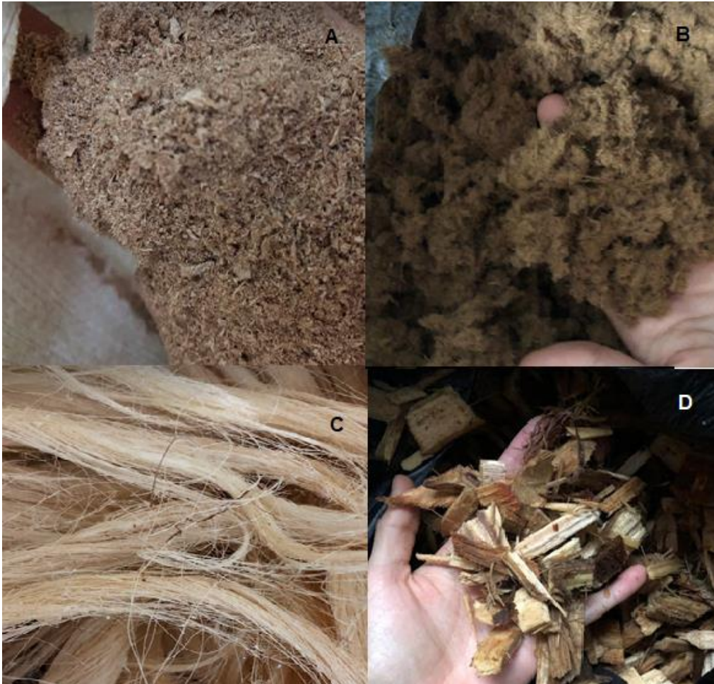
Figura 3-2 Conformación del sustrato. A: Aserrín, B: Fibras de Eucalipto y Pino, C: Fibra de fique, D: Chips
