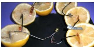
4. El cable de cobre y el cable de acero galvanizado que quedaron libres, conéctalos a los terminales del bombillo led o bombillo de bajo consumo de energía.
