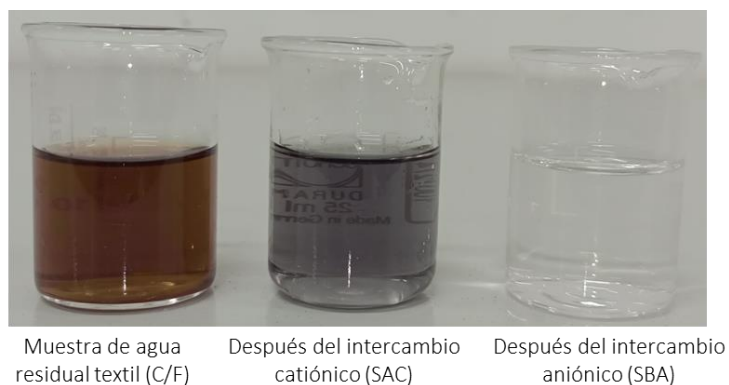
Figura 3.6. Coloración del agua residual textil antes y después del tratamiento de intercambio iónico.
