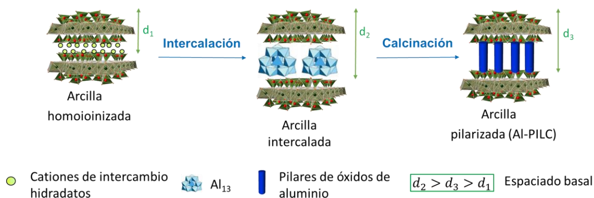
Figura 2.6. Representación de la síntesis de una arcilla pilarizada con aluminio. Adaptado de Gil et al., (2000) [36].
