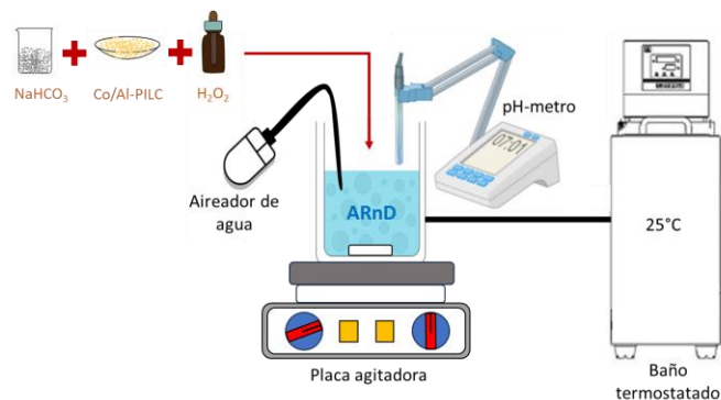
Figura 4.1. Montaje para la oxidación del agua residual textil empleando el sistema Co/Al-PILC-BAP.
