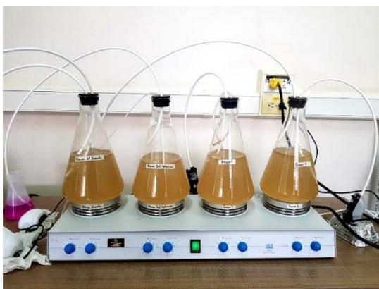
Figura 3.5. Montaje del tratamiento biológico – Prueba de Zahn-Wellens.
