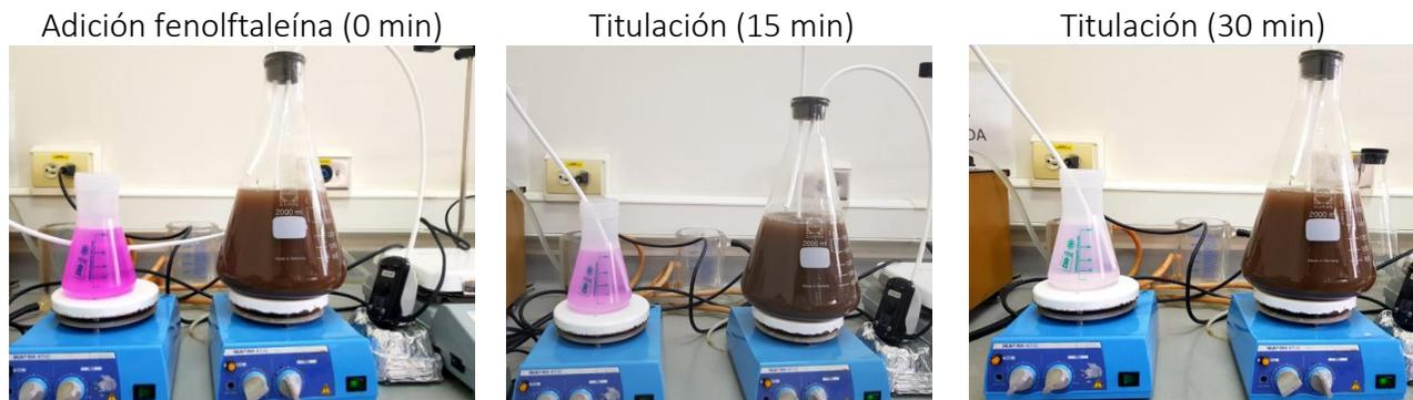
Figura 3.3. Registro fotográfico que muestra la neutralización del CO<sub>2</sub>.
