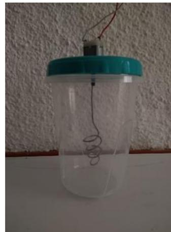
Prototipo de tanque floculador
