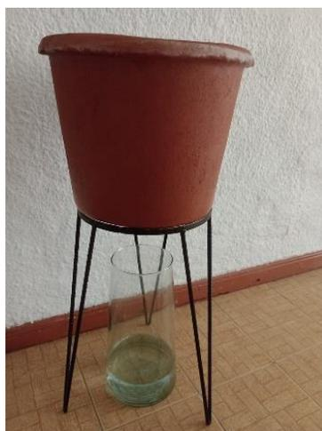
La adsorción es una de las propiedades de la arcilla, por lo que los filtros fabricados con este material los hace útil en descontaminar aguas mediante sus poros microscópicos que dejan pasar el agua reteniendo todas las partículas en suspensión. Los iones de metales, metaloides y químicos tóxicos también son retenidos por adsorción. Existen varios tipos de filtros en la categoría de arenas, y de materiales arcillosos, por lo general el primero se
