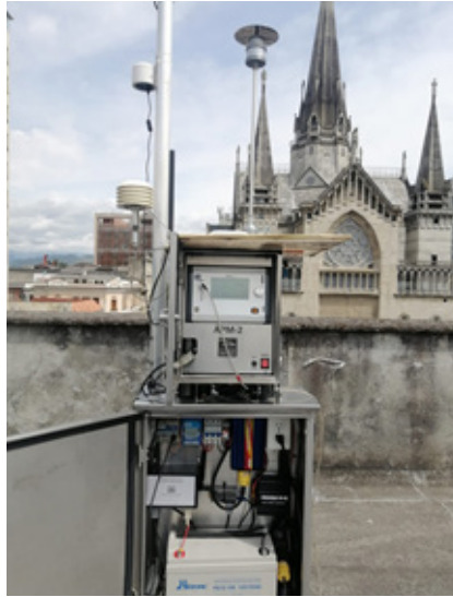
Figura 4. Fotografía del analizador APM-2 ubicado en la estación Gobernación Fuente: elaboración propia
