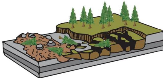
**Figura 2-3.** Propagación lateral en bloque de rocas o suelos. Modificado de Cruden & Varnes (1996).
