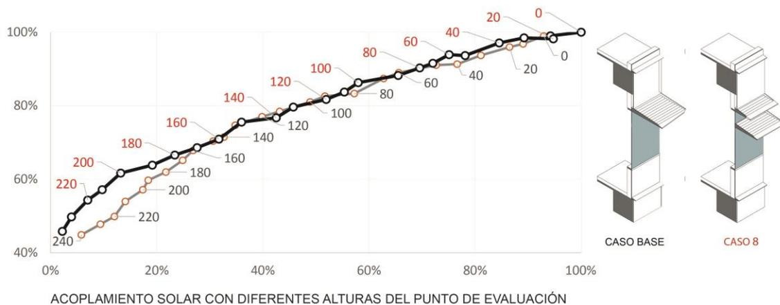
Figura 9: Diagrama de Acoplamiento Solar de dos vanos empleando 24 puntos de evaluación a diferentes alturas, comenzando a nivel del suelo y subiendo cada vez 0.1m hasta alcanzar los 2.40m sobre el piso.
