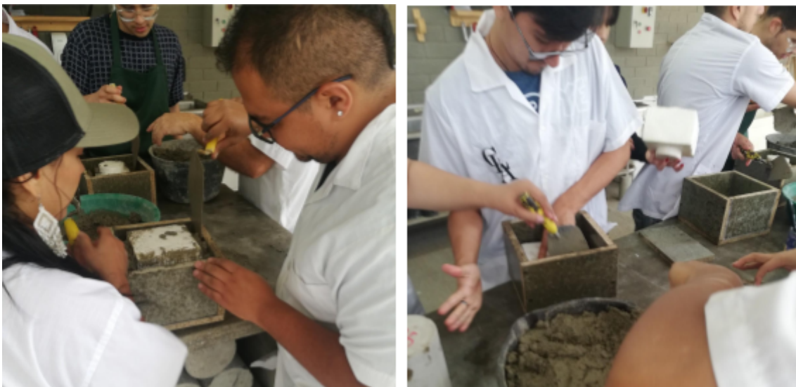
Figura 2 – Proceso de vaciado en concreto de los prototipos de elementos calados que fueron diseñados y analizados desde el punto de vista acústico y de ventilación por cada grupo de estudiantes matriculados en el curso Énfasis en Arquitectura Bioclimática. Luego de esta etapa se comenzaron a realizar las pruebas físicas con sonómetros. Fuente: Ader García, 2019.
