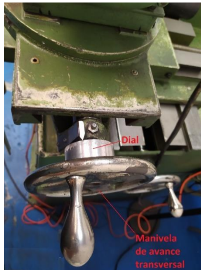
Figura 16: Sistema aplicación de profundidad de corte a la probeta.
