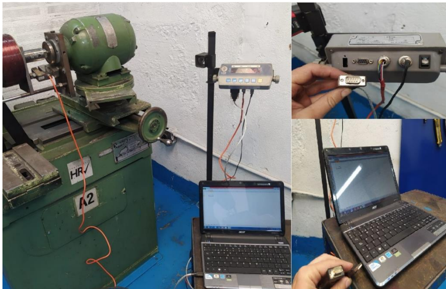
Figura 17: Conexión del computador portátil al Display de la celda de carga.
