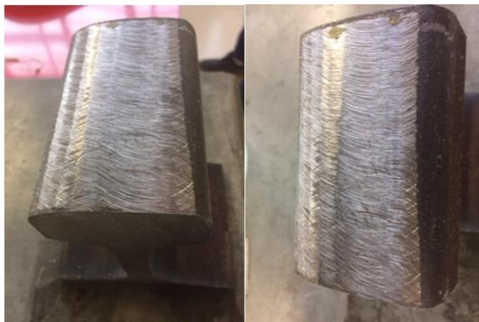
Figura 2-21: Aspecto general de la superficie esmerilada.
