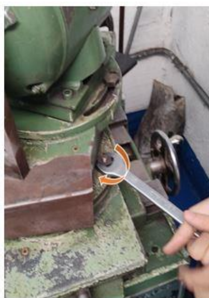
Figura 4: (A) Tornillo de ajuste de posición del Carro longitudinal. (B) Alineación del carro longitudinal
