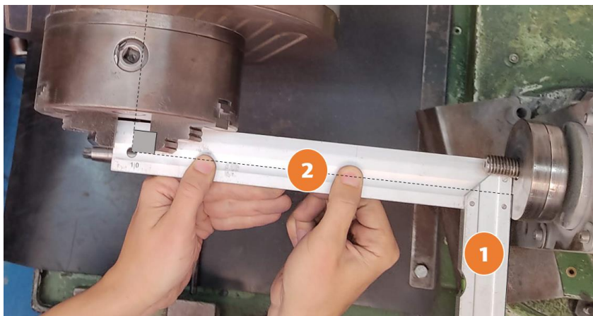
Figura 4: (A) Tornillo de ajuste de posición del Carro longitudinal. (B) Alineación del carro longitudinal
