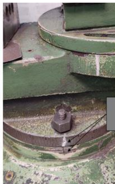
Figura 4: (A) Tornillo de ajuste de posición del Carro longitudinal. (B) Alineación del carro longitudinal
