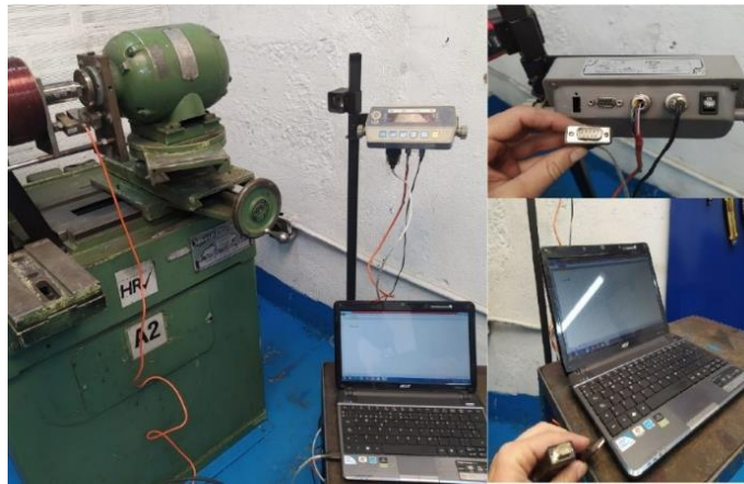
Figura 3-11: Conexión del computador portátil al display de la celda de carga.
