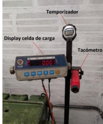
Figura 3-10: Sistema toma de medidas.
