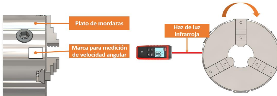
Figura 14: Instrucciones para el posicionamiento del tacómetro digital con respecto al plato de mordazas.
