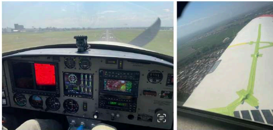
Figura 57. Pruebas en vuelo con sensores FBG, en plano derecho del T-90 Calima. Fuente: Autor.
