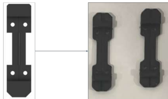
Figura 30. Galgas de material compuesto manufacturadas en impresión 3D, para adaptar los sensores FBG a los planos de la aeronave.
