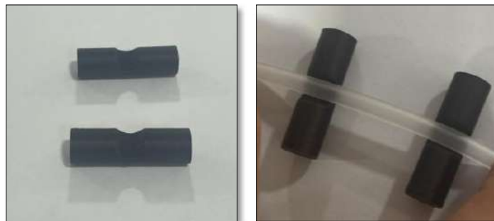
Figura 33. Cilindros de fibra de carbono para adaptar las fibras FBG a las pruebas de flexión. Fuente: Autor.
