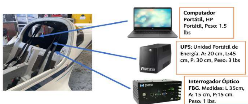
Figura 54. Implementación primera fase del sistema de monitoreo en el plano derecho del T-90 Calima.
