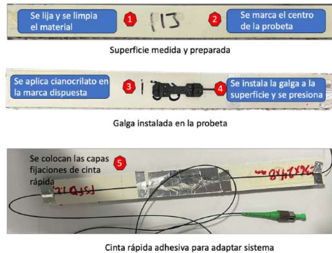
Figura 34. Proceso de implementación de galgas a probetas para caracterización en ensayos mecánicos de tensión y flexión.
