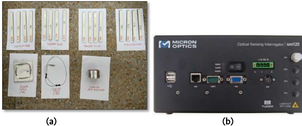
Figura 32. (a) Probetas para ensayos (b) sistema interrogador de sensores FBG. Fuente: Autor.
