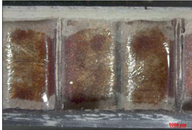
Figura 23. Microscopía óptica escala 1000 \mu\text{m} del material compuestos de matriz polimérica extraído de la piel los planos del T-90 Calima.
