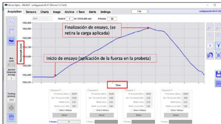
Figura 43. Visualización del sistema de adquisición de datos del sensor FBG (A), durante el ensayo a flexión.
