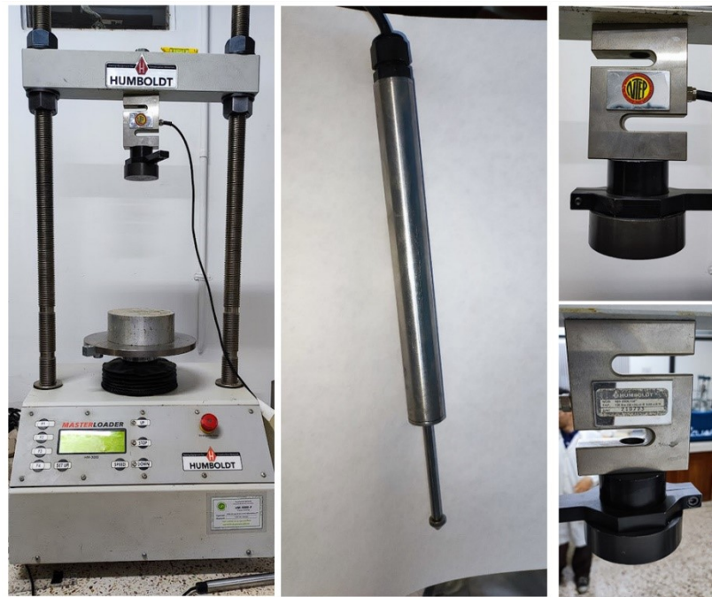
Figura 2-3: Banco de carga Máquina Humboldt HM-3000 (Izq.) – Deformímetro LVDT (Centro) – Celda de carga 50 kN (Der.)
