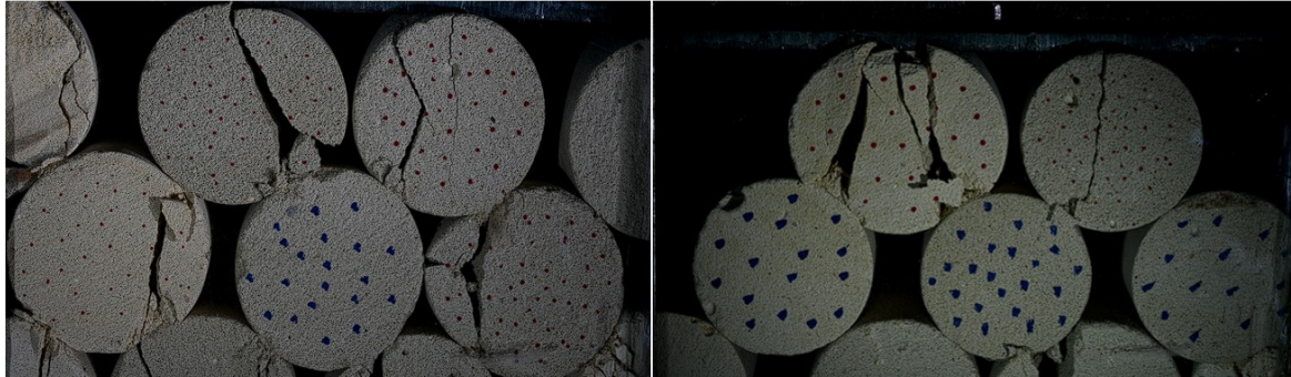
Figura 2-50: Resultados de ensayos de compresión edométrica para sujetos circulares. Izq.: E.G. Cir. # 1 – Der: E.G. Cir. # 2
