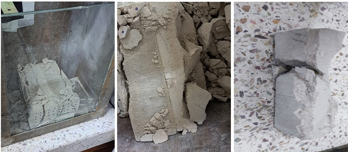
Figura 2-54: Estado de probetas cuadradas después del ensayo
