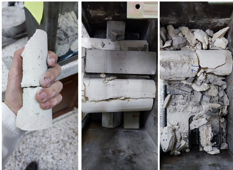
Figura 2-57: Estado de probetas de formas diversas después del ensayo
