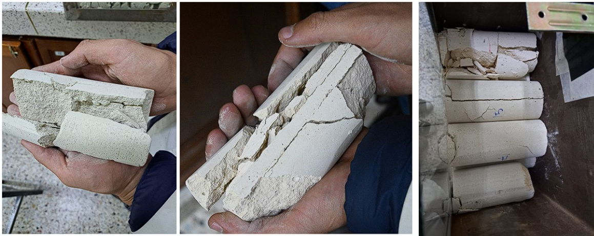
Figura 2-51: Estado de probetas circulares después del ensayo
