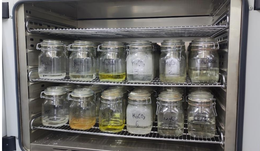
Figura 3-4: Montaje experimental de las isotermas de sorción. Elaboración propia
