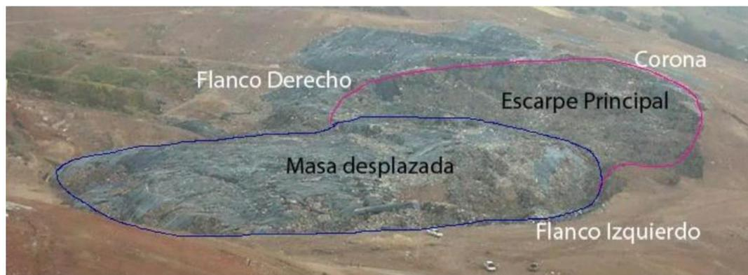
Figura 2-9. Fotografía aérea del movimiento de remoción en masa del 02 de octubre de 2015.
