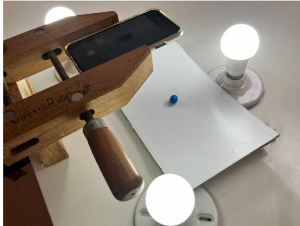
**Figura 5-4:** Montaje para la adquisición de las imágenes con el soporte para el teléfono móvil, una muestra de un dulce y la disposición de la iluminación.
