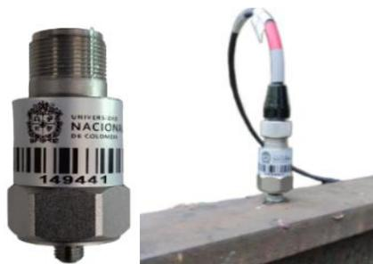
**Figura 3-8:** Acelerómetro uniaxial CTC AC210 y acoplamiento en riel.
