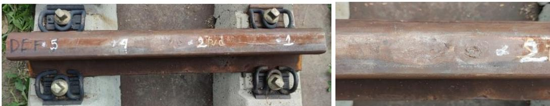
**Figura 4-13:** Riel condición 1, puntos de impacto y vista detalle punto 3.
