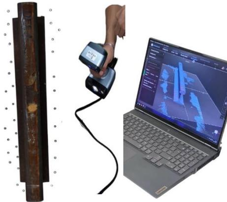
**Figura 3-19:** Sistema escáner 3D.
