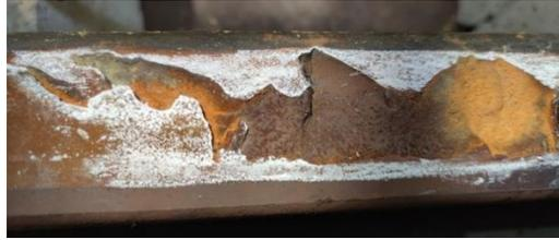
**Figura 3-18:** Vista detalle huella riel condición 4.
