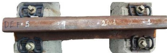
**Figura 4-32:** Puntos de impacto riel condición 1.
