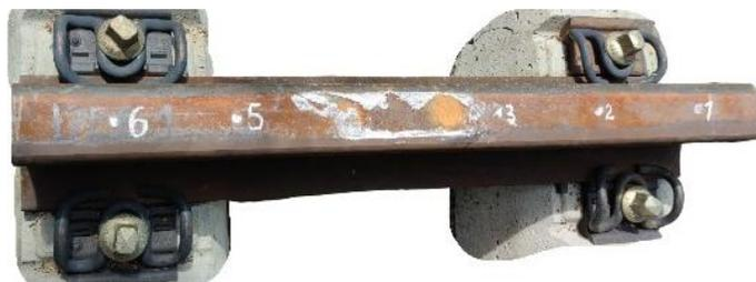
**Figura 4-34:** Puntos de impacto riel condición 4.
