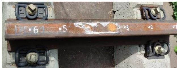
**Figura 3-17:** Puntos de impacto riel condición 4.
