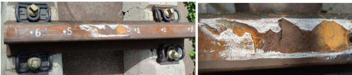
**Figura 4-17:** Riel condición 1, puntos de impacto y vista detalle punto 3.
