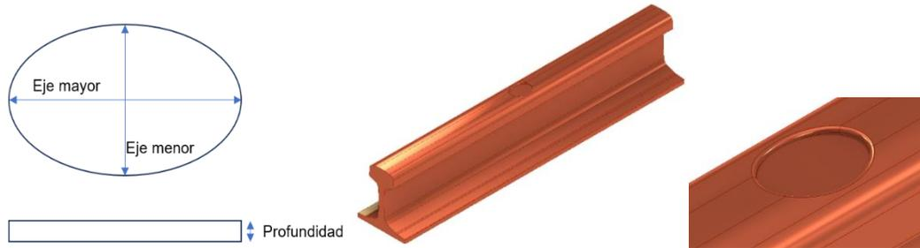
**Figura 3-5:** Perfil huella generación de condiciones.
