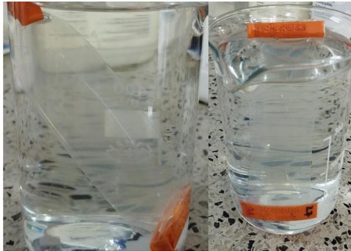
Finalmente se deja reposar durante 2 horas y se renueva el medio inocuo (solución buffer) para asegurar la purificación de la enzima, esto debe realizarse 3 veces.
