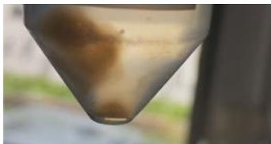
Una vez obtenido el pellet, rápidamente separe el sobrenadante del precipitado y marque la zona del tubo con un círculo el lugar donde se encuentra el pellet
