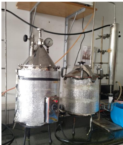
Figura 7. Extractor por arrastre de vapor a escala piloto del laboratorio de Productos Naturales Vegetales del Departamento de Química de la Universidad Nacional de Colombia
