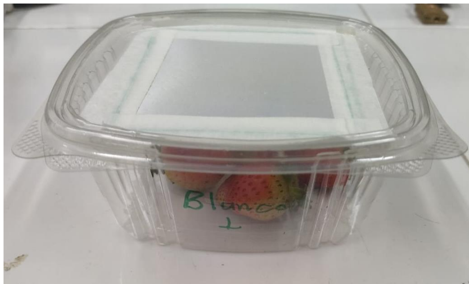
Figura 43. Montaje ensayo prueba in vivo de efecto inhibitorio de LEO-HD en fresas con adición de película de PHBV/PLA/MC-Est.
