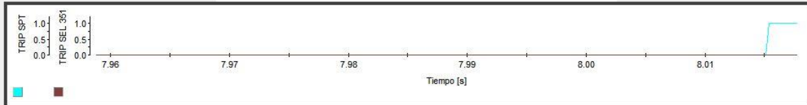
Figura. 67 Falla monofásica con impedancia de falla 150 \Omega
