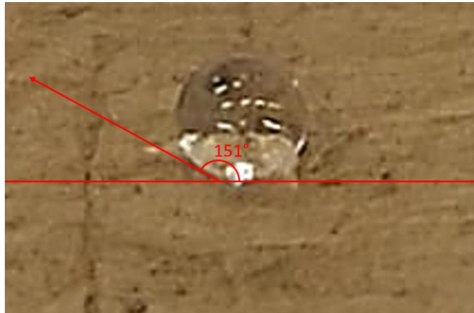
Figura 40. Evaluación del ángulo contacto para la membrana funcionalizada con el MI
