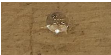
Figura 39. Prueba de afinidad al agua de la membrana funcionalizada con MI
