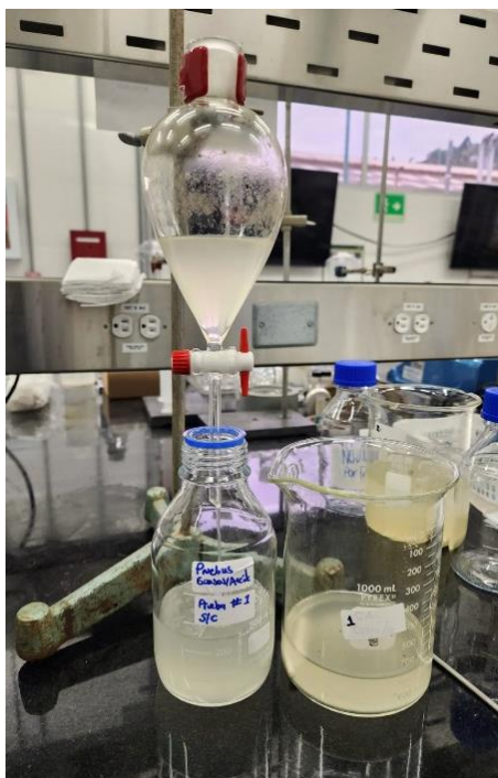
Figura 15. Proceso de separación del aceite libre la PW sintética
