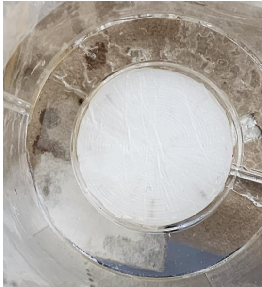
Figura 36. Membrana sin funcionalizar después de la primera prueba de medición de permeabilidad
