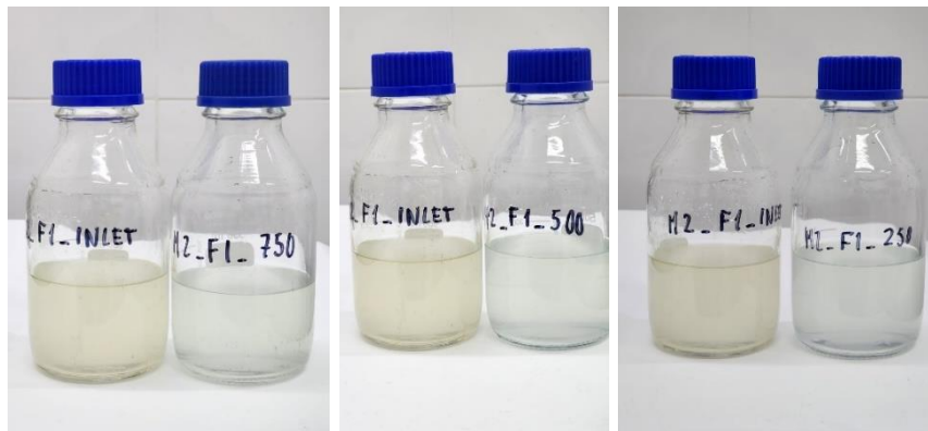
Figura 44. Muestras de primer ciclo de filtración realizado por la MEMBRANA #2
