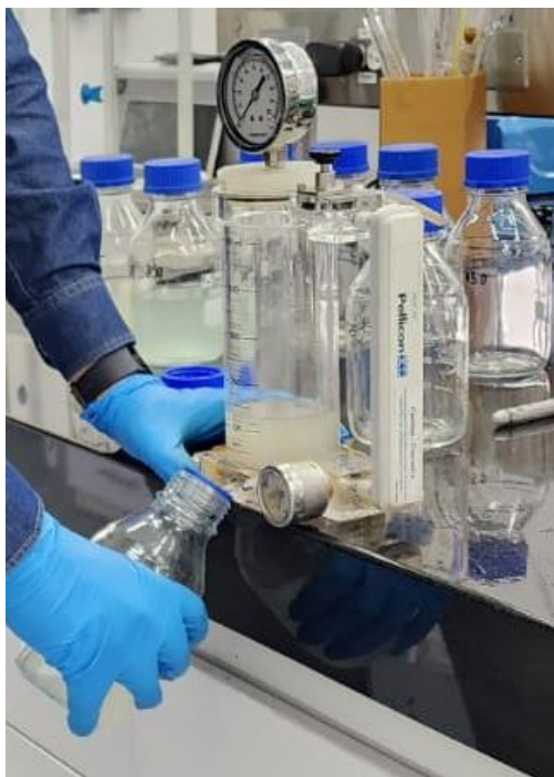
Figura 18. Filtración de PW sintética, usando el dispositivo de filtración y las membranas evaluadas
