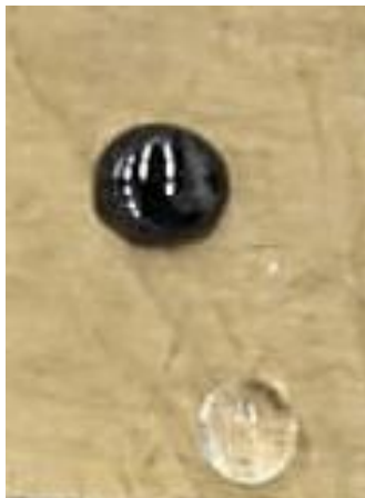
Figura 42. Prueba de afinidad al aceite de la membrana funcionalizada con MI, luego de ser estimulado con luz UV durante 10 minutos
