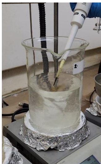
Figura 14. Adición de 60 µL de crudo pesado a la matriz acuosa
