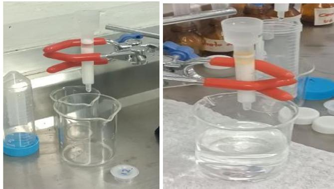
**Fotografía 3 y 4.** En la fotografía 3 se observa la preparación inicial de la columna con la resina luego de retirarle los tapones inferior y superior dejando que drene el líquido con el cual viene preparada. En la fotografía 4 se observa la resina mientras va drenando la muestra adicionada a esta.
