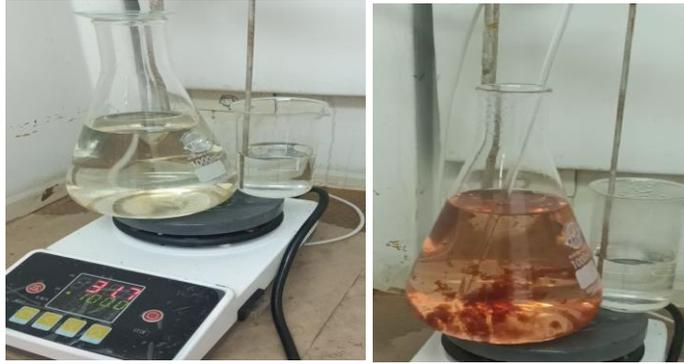
**Fotografía 1 y 2.** En la fotografía uno se observa el calentamiento inicial de la muestra a punto de ebullición con ácido nítrico, 1 ml de Plomo y 1 ml de Hierro. En la fotografía 2 se observa el punto rosa de la fenolftaleína luego de agregar Hidróxido de Amonio, además, se observa el precipitado obtenido donde están los radionúclidos de interés en la medición.
