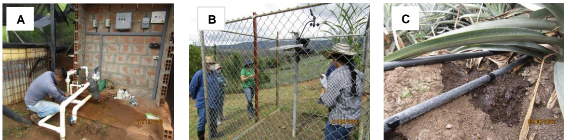
(A) Sistema de riego automatizado. (B) Estación meteorológica marca Lynkbox. (C) Cintas de riego por goteo.
