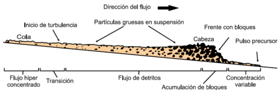
Figura 4-2 Corte Esquemático típico de un flujo de detritos.
