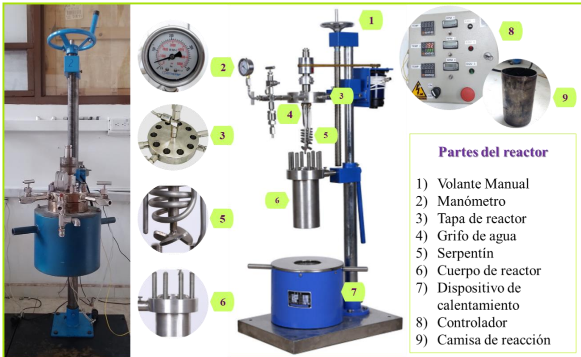
Figura 3-4: Reactor de alta presión de síntesis hidrotermal de acero inoxidable autoclave
