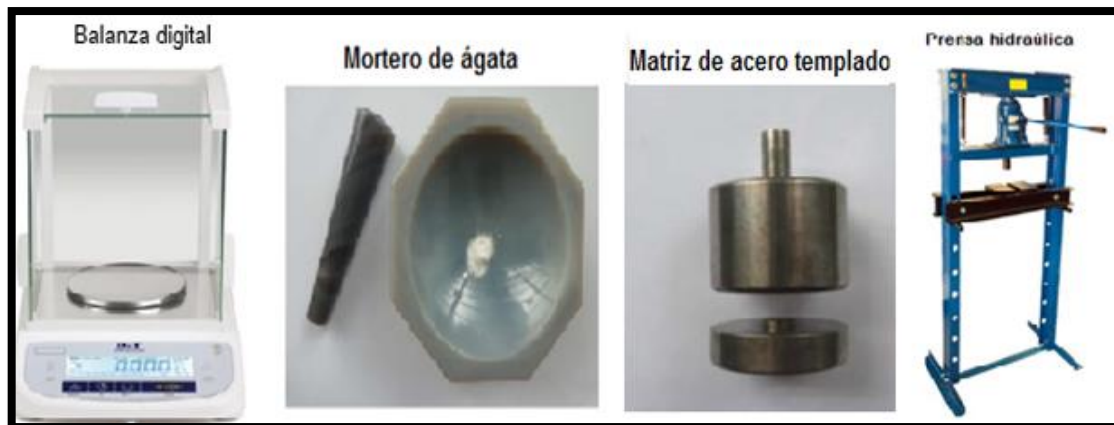
Fig. 11. Instrumentos empleados en los procesos de síntesis de muestras.
