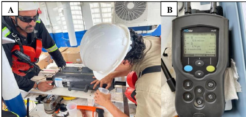
Figura 13. Toma de muestras de agua de fondo. A. Las muestras son tomadas a boca de botella para evitar la oxigenación del agua y son medidas inmediatamente con la sonda multiparamétrica. B. Sonda multiparamétrica realizando la medición del pH y la conductividad en una muestra de agua.
