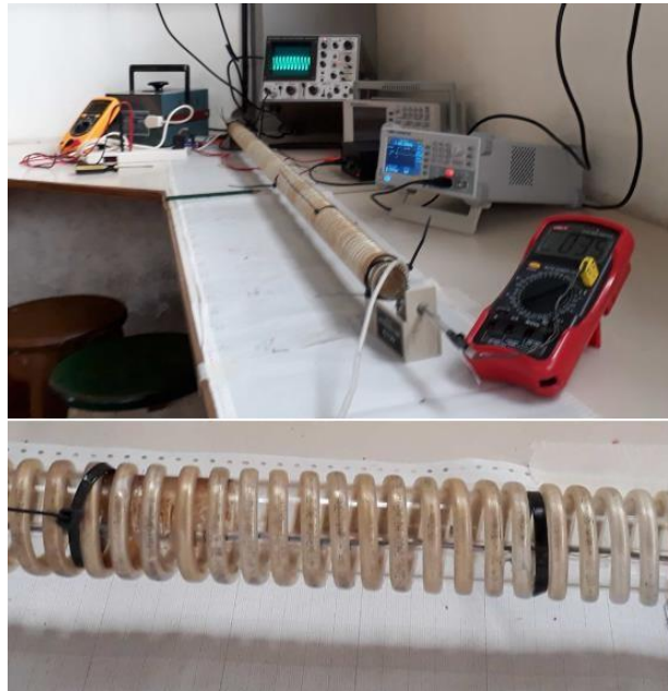
Figura 2: Dispositivo experimental tubo de Kundt para medir la velocidad del sonido con respecto a la temperatura.
