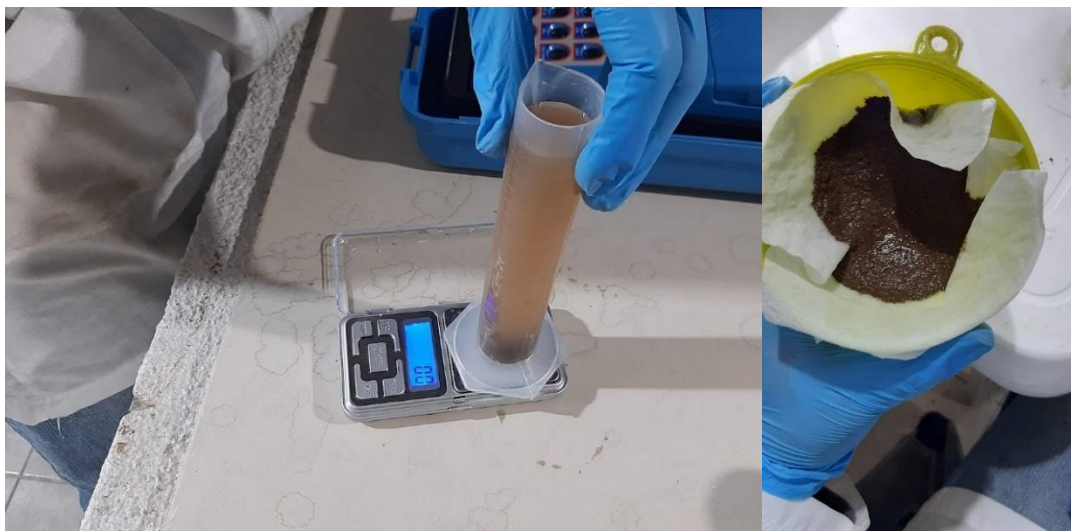
Figura 38. Determinación de densidad y resultado de filtración
