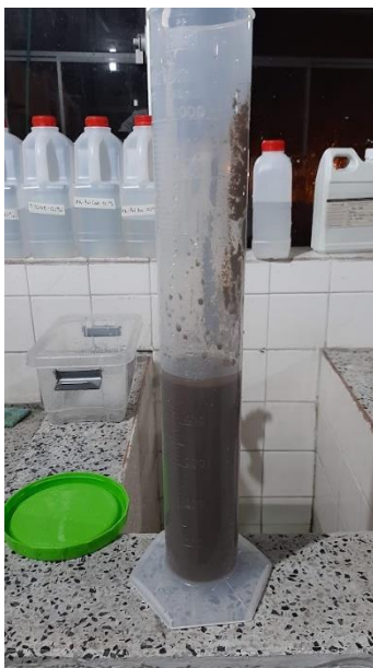
Figura 41. Muestra de lodos espesada con los químicos seleccionados
