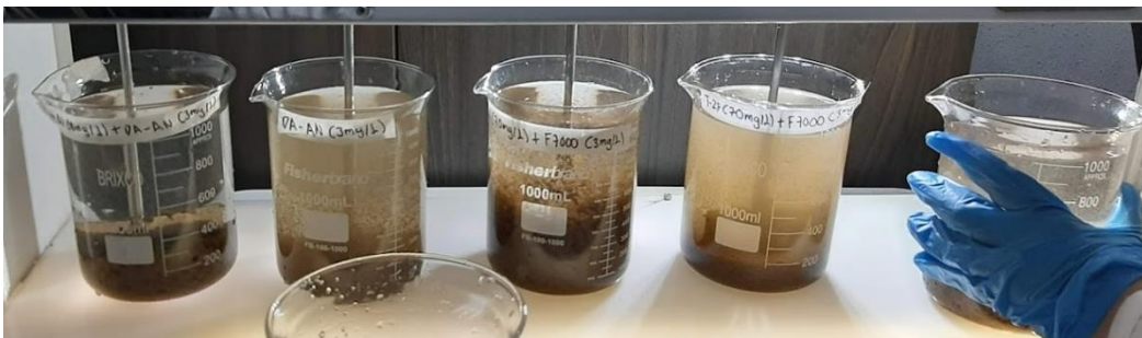
Figura 36. Resultados de las pruebas finales, después de dos minutos de sedimentación
