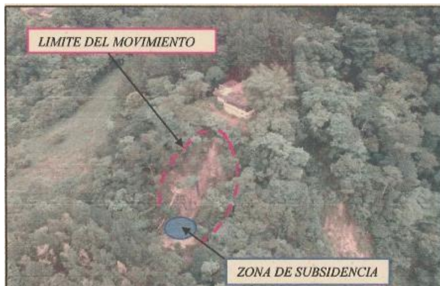
Figura 6.13.1. Zona de afectación en perfil geológico Túnel Buenavista.
