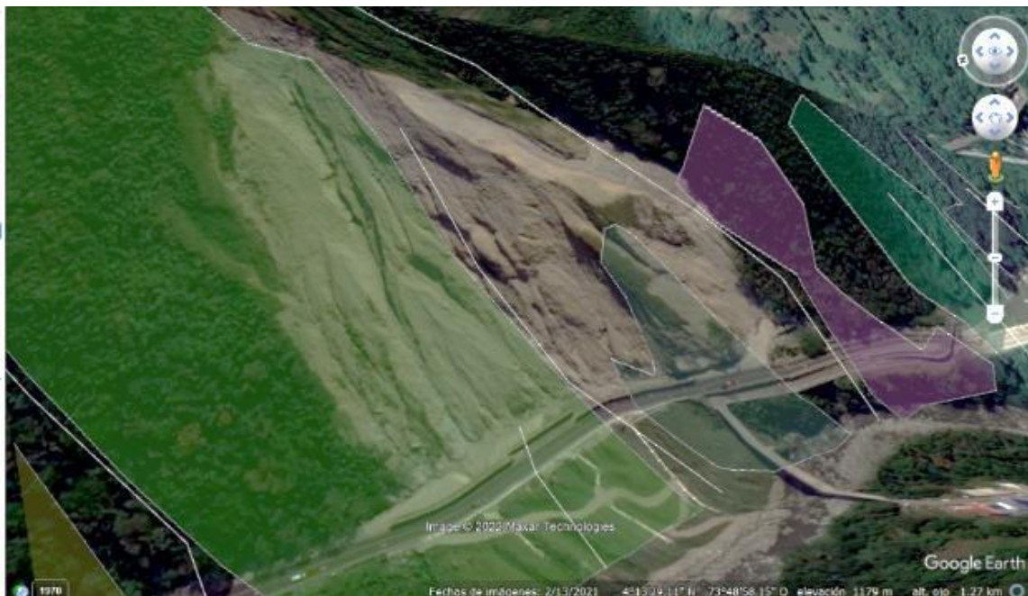
Figura 4.9.14 Parte profunda del deslizamiento representada por polilíneas y por consiguiente por flujo >3000
