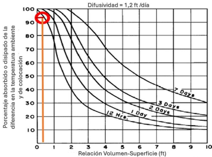
Figura 4.11: Gráfica 4.6 ACI 207 2R, porcentaje absorbido o disipado entre la diferencia de temperatura ambiental y de colocación
