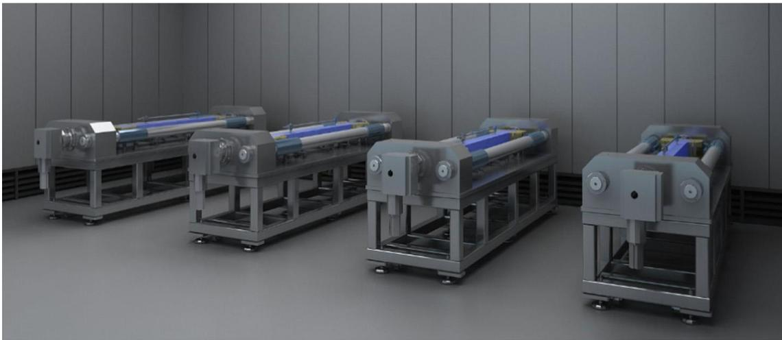
Figura 3.2: Laboratorio y ambiente artificial para múltiples muestras TSTMs.
