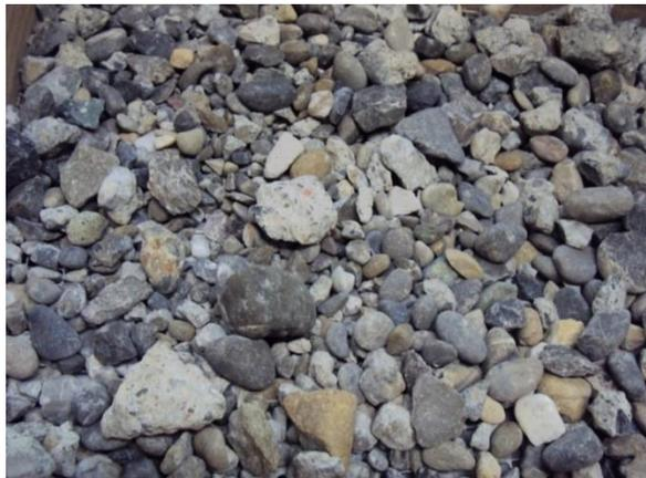
Fotografía 37. Agregado grueso reciclado para hormigón; Dübendorf, Suiza.
