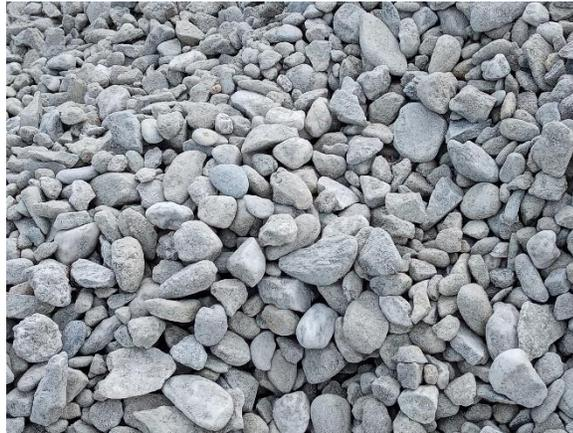
Fotografía 2. Agregado grueso (grava) para producir hormigón.
