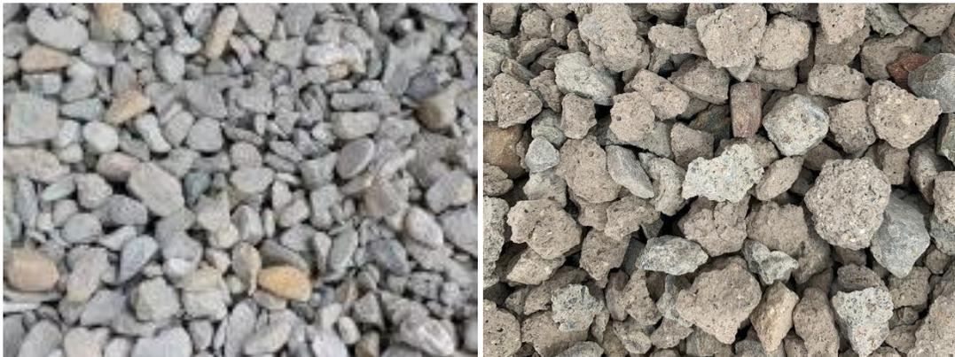
Fotografía 16. Agregado grueso natural (izq.); agregado grueso reciclado (der.).
