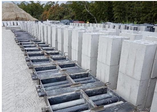
Fotografía 4. Bloques (bordillos) prefabricados de hormigón, en Marinilla, Colombia.
