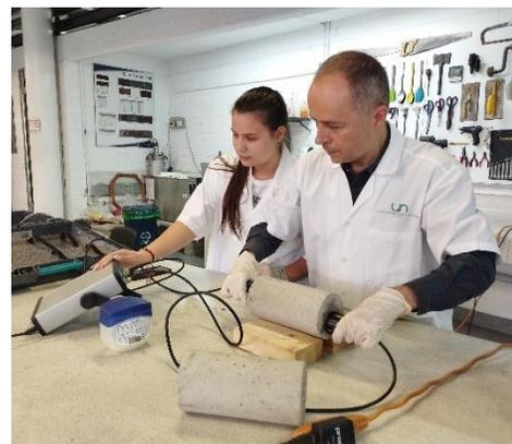
Fotos 67 y 68. Muestras cilíndricas (izq.); Ensayo de velocidad de pulso ultrasónico – VPU.
