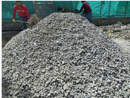
Fotos 61 y 62. Arena reciclada (izq.); Agregado grueso reciclado (der.).
