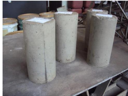
Fotos 30 y 31. Probetas cilíndricas (fraguado y endurecido) para ensayos de resistencia y durabilidad. Fuente: Bedoya, C. (2013).
