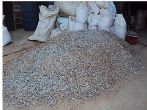
Fotos 26 y 27. Escombros en el campus UNAL sede El Volador, transformados en agregados reciclados en el CIMEX.
