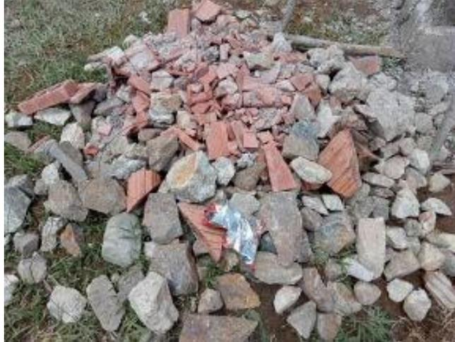
Fotografía 35. RCD: escombro de concreto, mortero y ladrillo cerámico.
