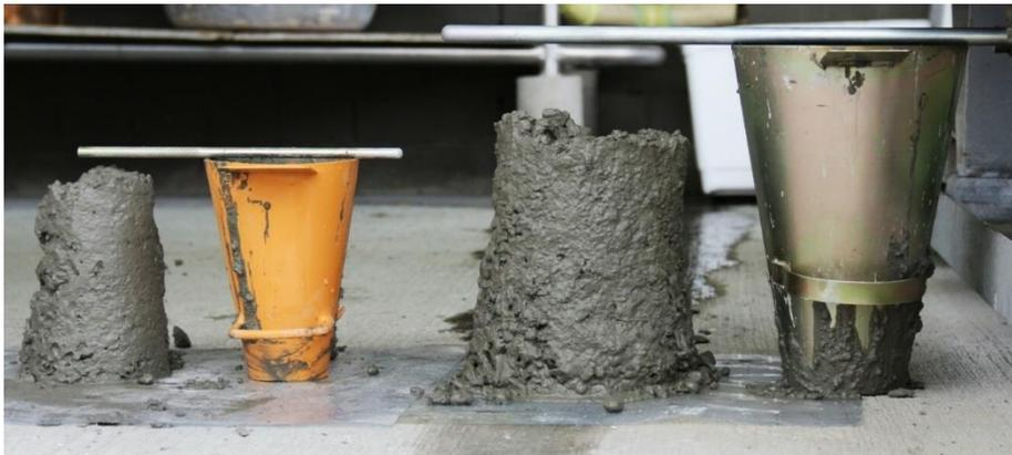
Fotografía 17. Ensayo de trabajabilidad del hormigón fresco, usando cono de Bedoya (izq.) y cono de Abrams (der.). Fuente: Unimedios (2019).
