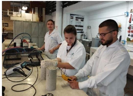
Fotos 69 y 70. Peso y densidad (izq.); medición de la humedad para la VPU.
