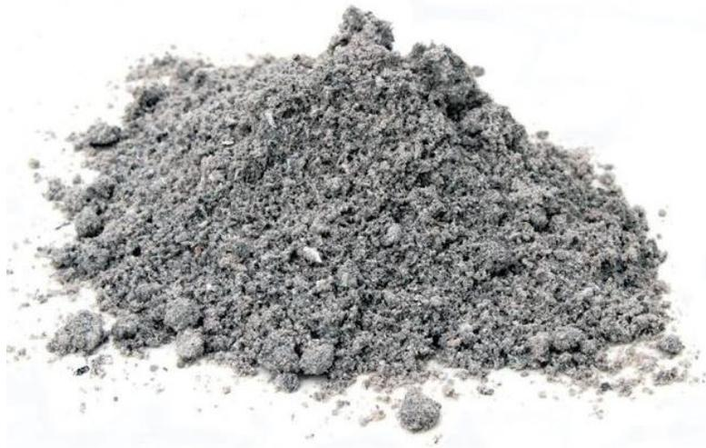
Fotografía 20. Cenizas volantes (Fly Ash) de carbón.
