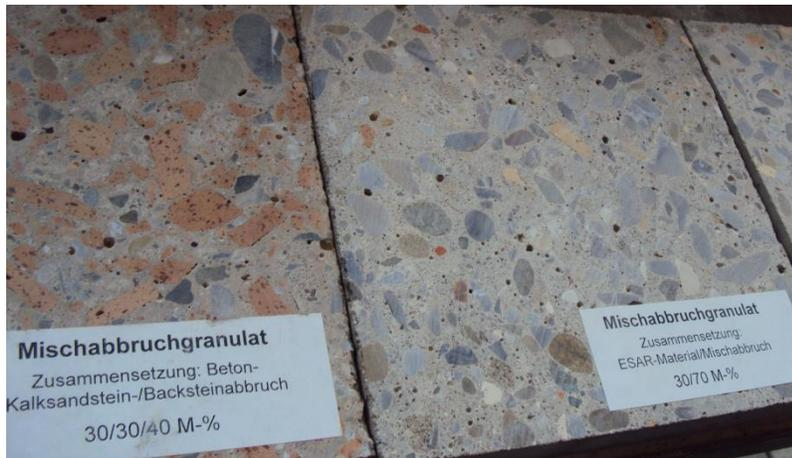
Fotografía 34. Superficies de hormigón reciclado; EMPA, Suiza.
