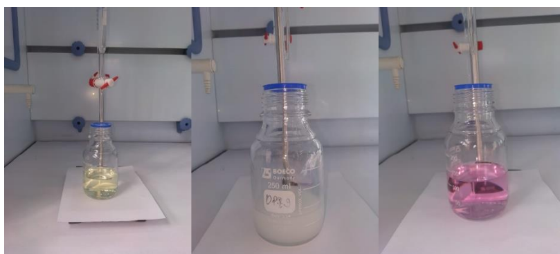
Figura 2-5. Prueba de medición de Número de hidroxilo.
