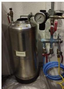
Figura 3-13. Cámara de presión para prueba de deformación Creep.
