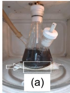
Figura 1-19. Reacción de depolimerización relación 1,2:1 (PET: DEG) (1%w/w catalizador): (a) PET sin reaccionar fondo del reactor (minuto 36)
