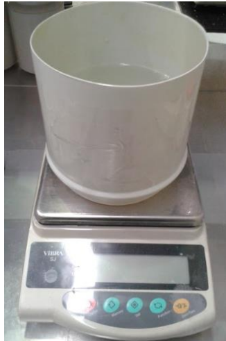
Figura 3-8. Determinación de densidad por inmersión en agua.
