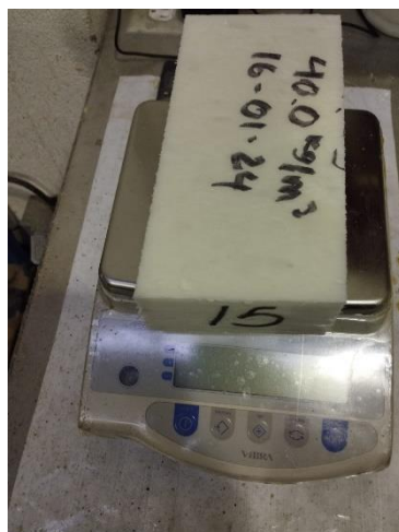
Figura 3-7. Determinación de masa de probetas molde Brett.
