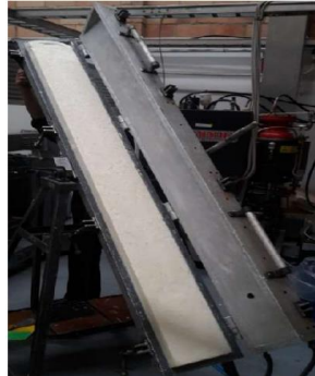
Figura 3-5. Espuma cargada en molde Brett.
