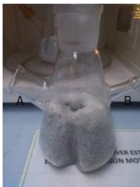
Figura 1-13. Reactor de 500mL con baffles, boca de toma de temperatura (A), boca de salida de vapores (B).
