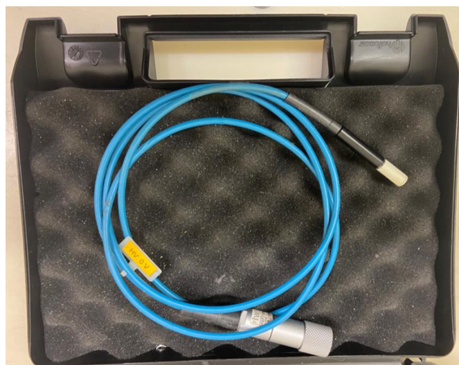
Figura 7.4.0-1: detector FLASH-Diamond T60025
