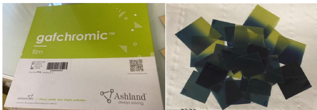
Figura 7.8.0-1: Película Radiocrómica EBT-XD
