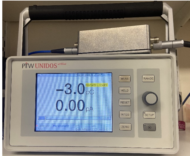
Figura 7.2.0-1: PTW UNIDOS webline Electrometer
