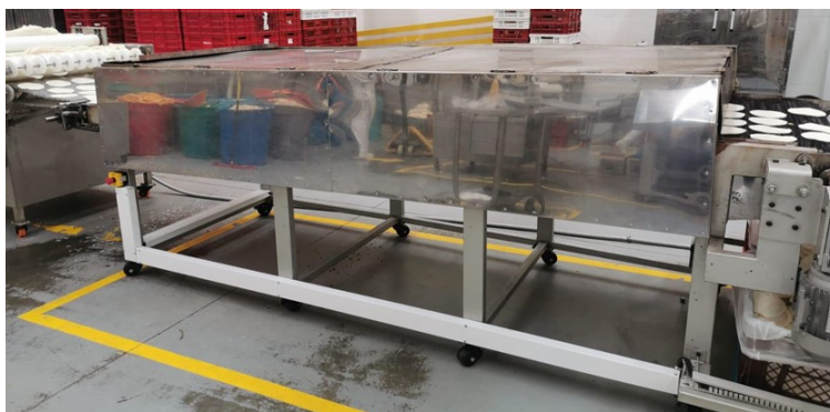
Figura 2-1: Horno continuo de arepas Arepas Memo FA SAS
