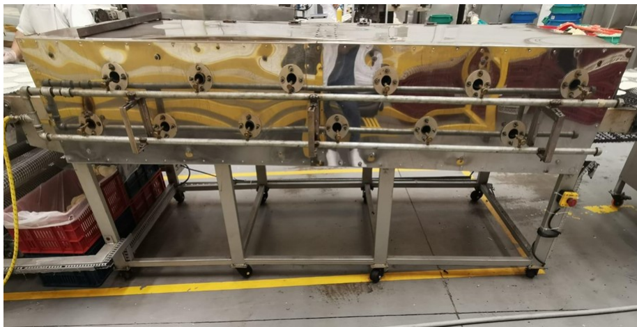
Figura 2-2: Horno continuo de Arepas tren de inyección de gas
