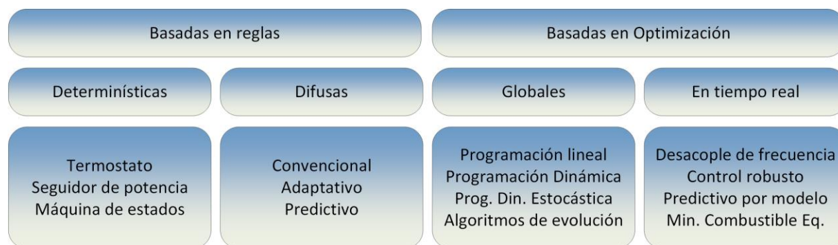
Figura 9. Técnicas para el control y la gestión de la energía en un SHAE. Adaptado de [14].
