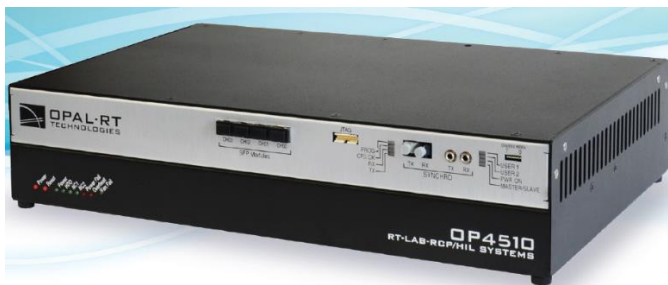
Figura 54. OPAL OP4510, para las tareas de simulación en tiempo real y la ejecución de los algoritmos de control
