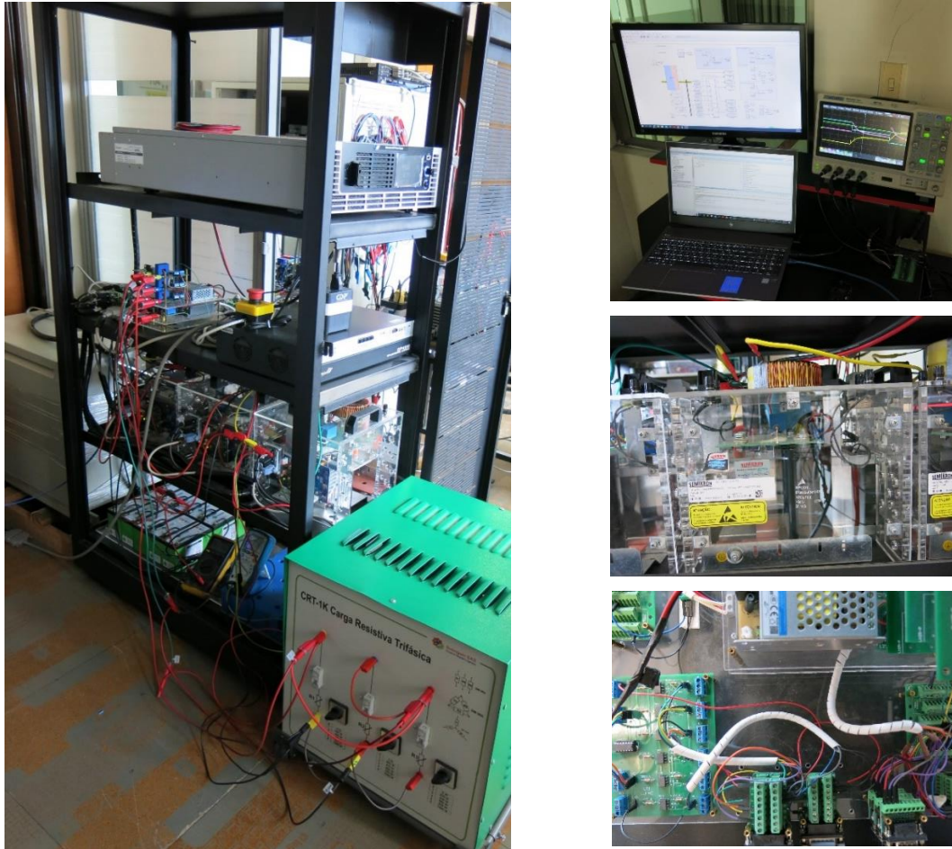
Figura 45. Fotografías de la microrred DC experimental, con un SHAE compuesto por baterías y supercondensadores 2 .
