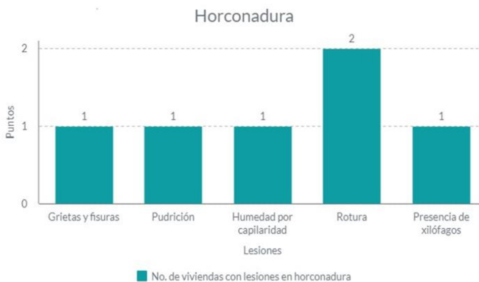
Figura 3-17: Lesiones presentes en la horconadura. Fuente: Creado por el autor a través de Piktochart.com (2022).
