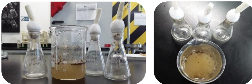
Figura C4. Final del tratamiento de exposición a crudo aceitoso de la microalga 60055 después de 1 mes de exposición se puede observar que los flóculos detectados en la Figura C2 se deshicieron.
