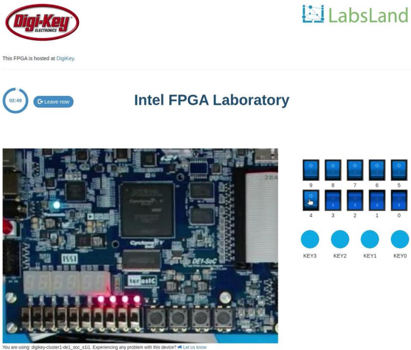
Figura 3-9.: Interfaz de Labsland donde se observa el comportamiento de una FPGA a través de una cámara, en tiempo real.
