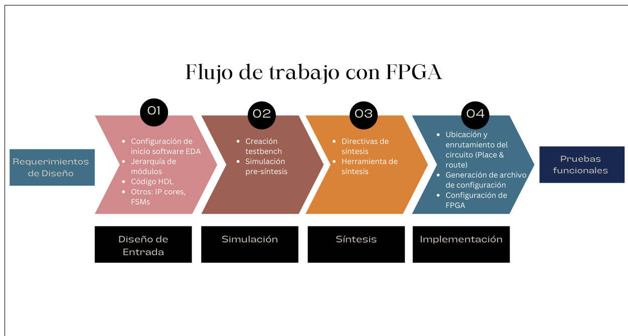
Figura 4-2.: Flujo de trabajo con FPGA simplificado. Basado en Ong et al. (2018) e Intel Corporation (s.f.).
