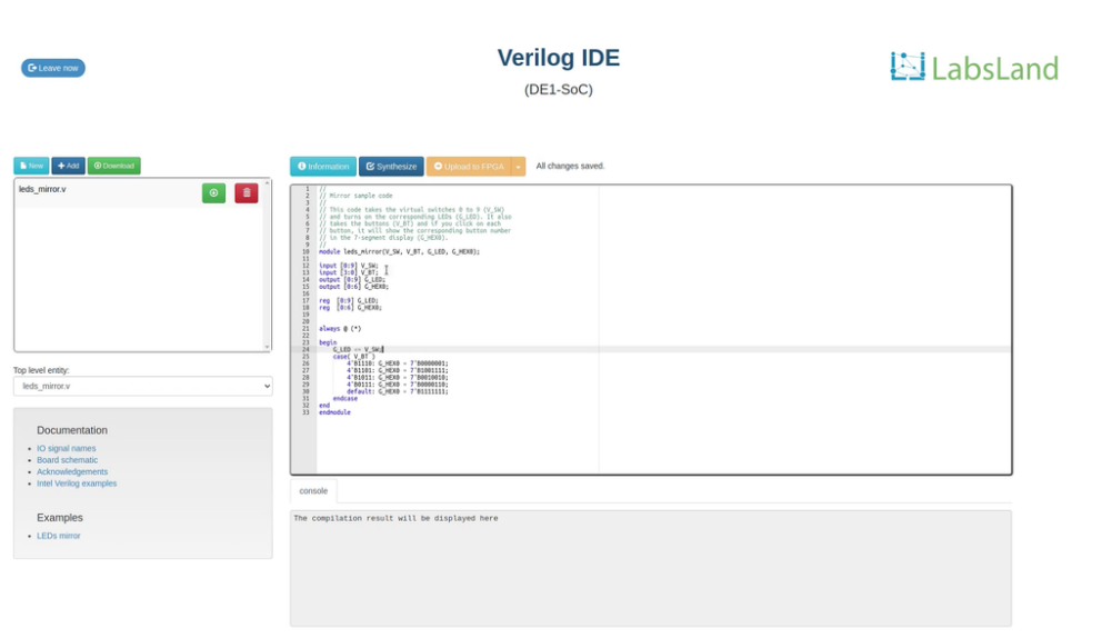
Figura 3-7.: Editor de código HDL en Labsland. Abajo se observa la consola donde se observa el proceso de síntesis y el despliegue de errores y advertencias. Tomada de https://labsland.com/es/labs/fpga-de2-115
