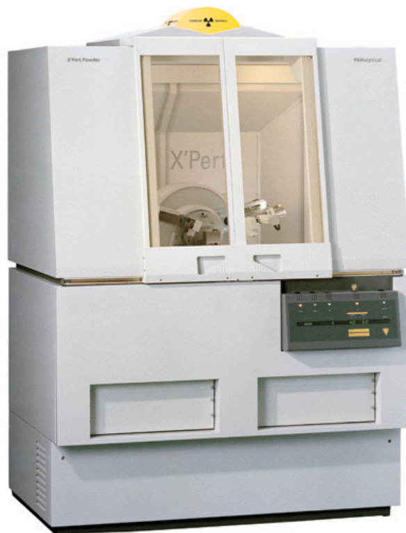
Figura 28. Sistema de DRX de PANalytical X'Pert PRO MPD
