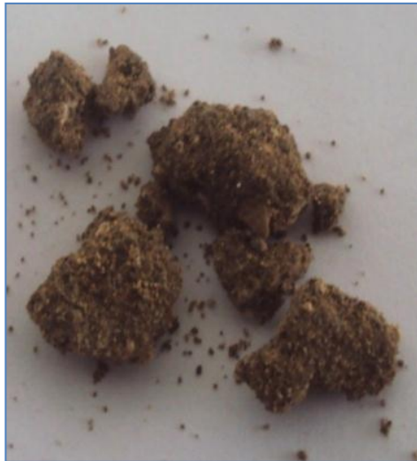
Ilustración 37. Muestra del mortero de pega del puente Ortiz en Cali (POMP)
