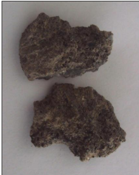
Ilustración 21. Muestra del mortero de pega del puente Cauca en Popayán
