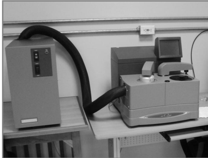
Ilustración 10. Calorímetro Diferencial de Barrido (DSC) de la Universidad Nacional de Colombia Sede Manizales
