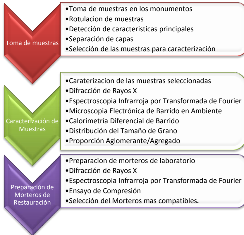
Ilustración 7. Procedimiento general para el análisis de morteros antiguos y formulación de morteros de restauración
