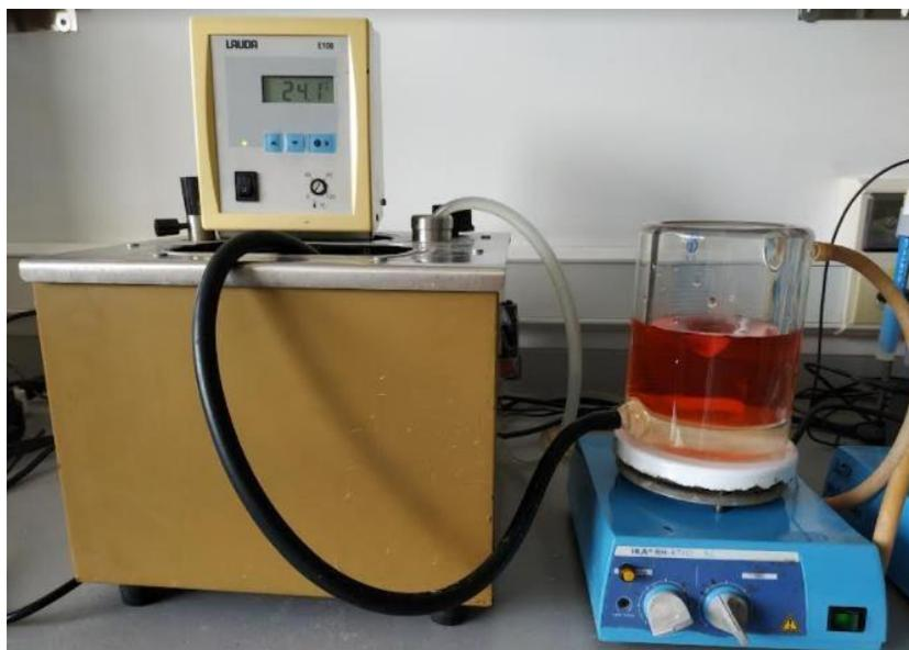
Figura 9. Montaje de reacción para la evaluación de la degradación del colorante rojo allura en solución acuosa con el sistema  $\text{Co}^{2+}/\text{NaHCO}_3/\text{H}_2\text{O}_2$  en medio homogéneo.
