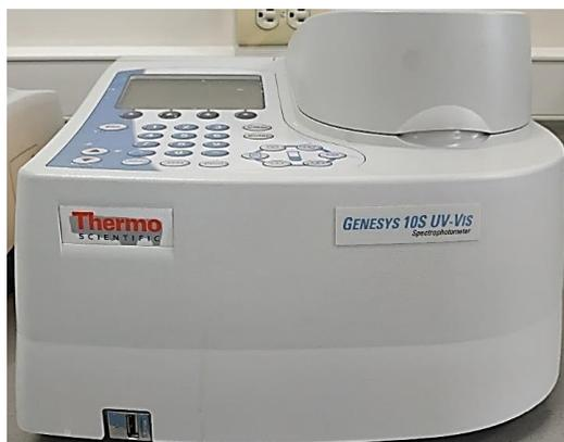
[Figura 14](#). Equipo de espectrofotometría Thermo Scientific UV-VIS Genesys 10S.
