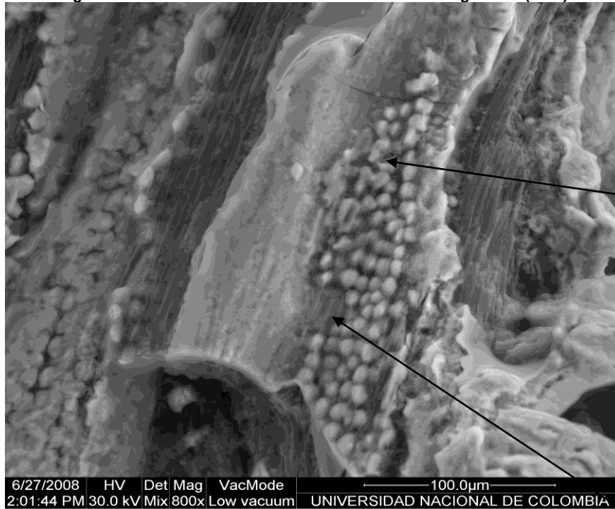
Figura 14. Adhesión de colonias sobre carbón activado granular (CAG)
