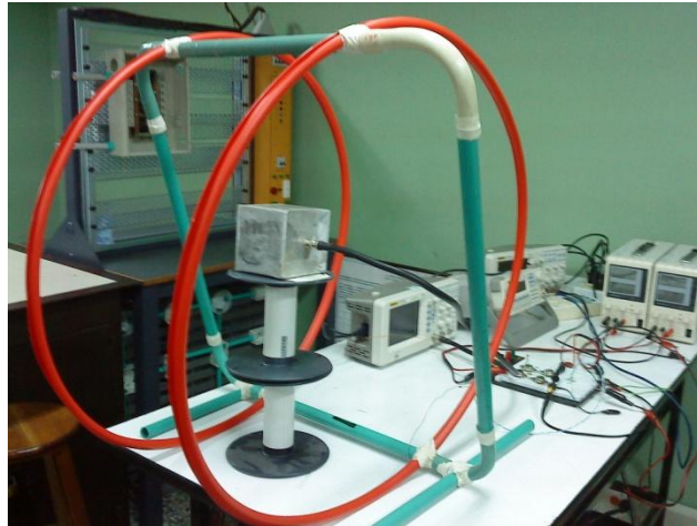
Figura 4.3 Montaje de la bobina Helmholtz para la medición de campo magnético a la frecuencia de 1MHz
