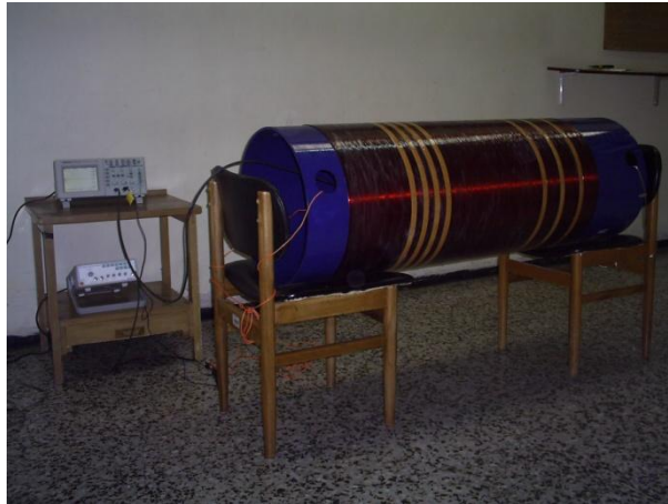
Figura 3.8 Montaje de la fuente de interferencia
