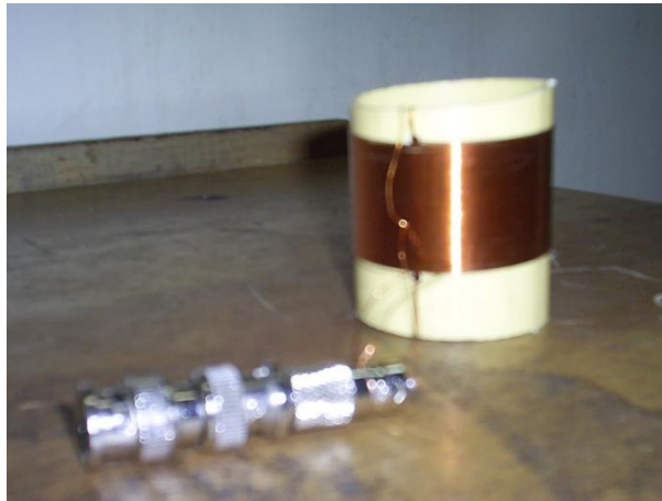
Figura 3.9 Sensor tipo solenoide de 100 vueltas
