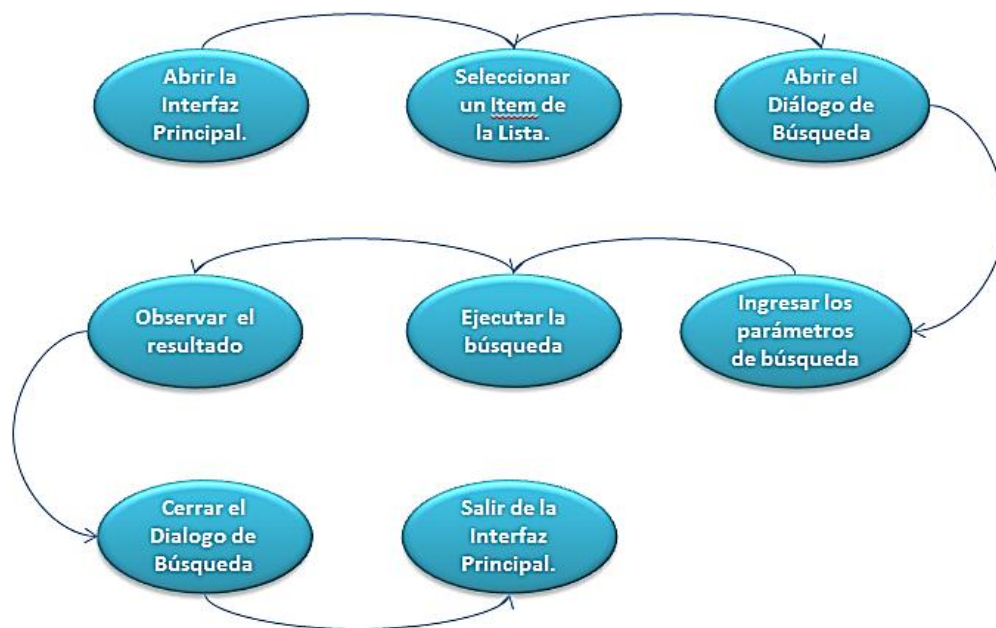
Figura 3-12: Ejemplo de la especificación de un escenario para un diálogo de búsqueda.
