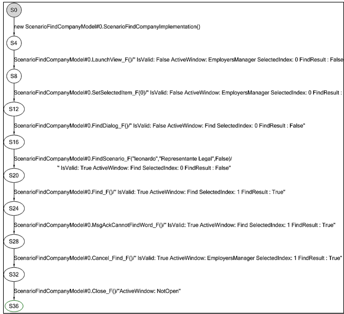
Figura D-27: Ejemplo de caso de prueba de alto nivel generado para el escenario de buscar una empresa.
