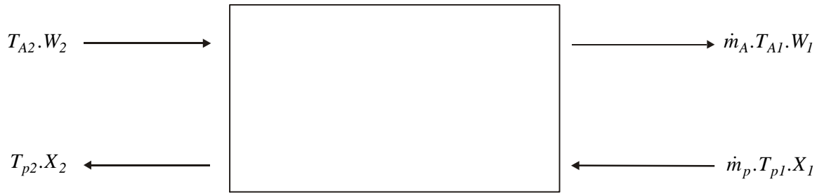
FIGURA 7.10 BALANCE DE MATERIA Y ENERGÍA EN UN PROCESO DE SECADO
